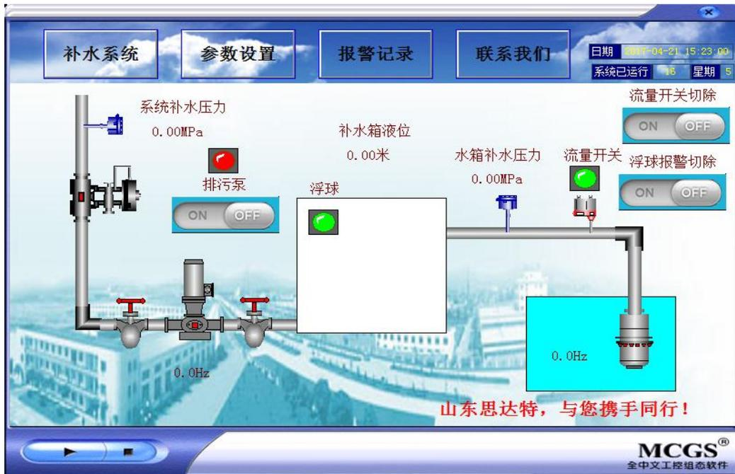
针对混水换热站，我们需要专门的补水站对管网进行补水。如果是间供换热站，往往是在就地对二次网回水进行补水。补水系统一般是定点定压控制，同时要兼顾补水箱的液位控制，
