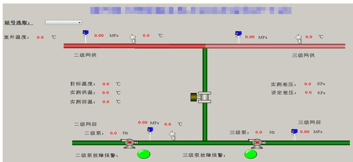
可以任意调取每个换热站的工作流程图，实时监控站内工作情况。
