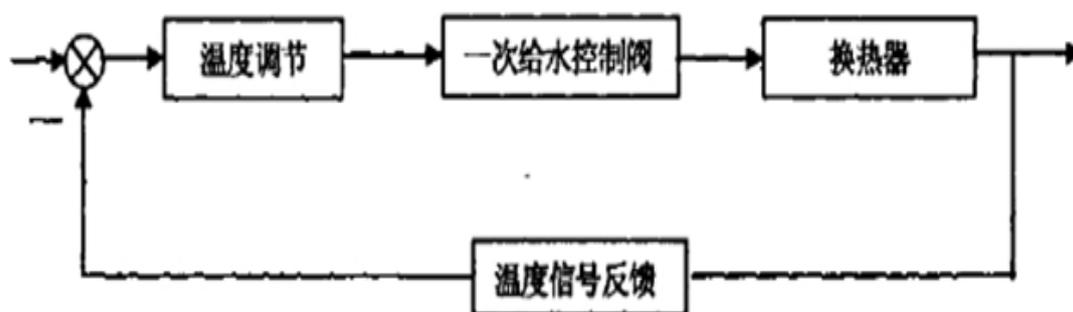
对于混水换热站一般采用电动调节阀+流量计的形式进行控制，即每个电动调节阀后安装一台流量计。运行时，根据二次侧的温度或一次侧与二次侧的流量反馈信号，调整电动控制阀的开度，使得各个混水站的一次、二次流量混合比达到设计值。这样可以灵活的调节各个混水站一次侧高温水和二次侧混入水的混合比，自动化程度高。
