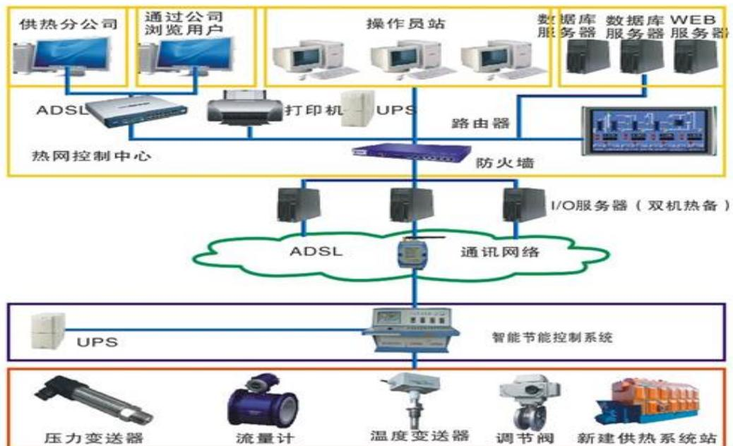
换热站的自动控制系统包括现场自动化控制系统、各个换热站与监控中心之间的通讯系统和监控中心管理系统三个部分构成。
