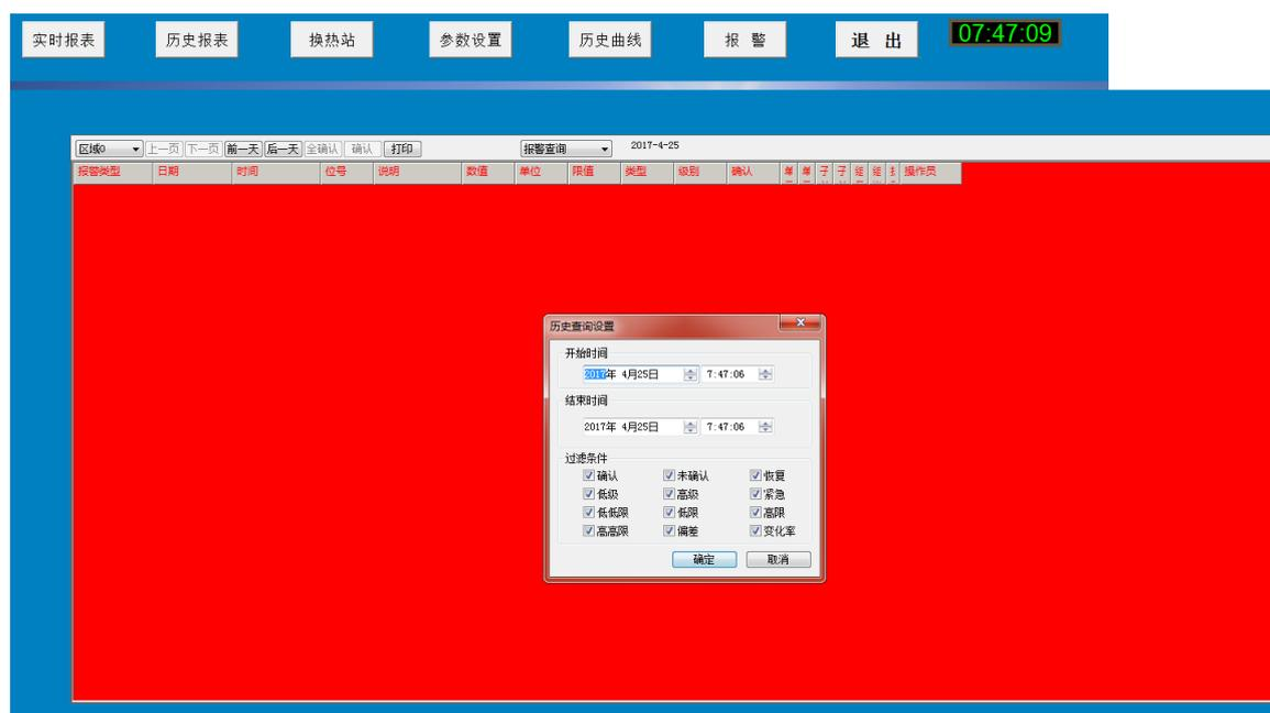
该画面可显示当前诸如温度、压力的报警，也可通过设置窗口进行历史报警的查询。此报警根据现场报警上下限设置，及时排查故障隐患。
