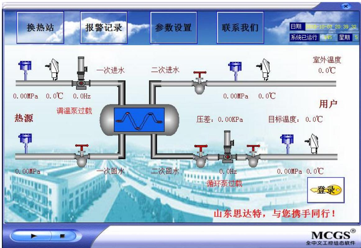
对于间供换热站，一次高温热介质（蒸汽或热水）在进入到各个换热器之前，在一次回水管上加装电动调节阀（调节一次网热介质流量），由系统进行自动闭环控制（也可选择手动控制）。系统将检测到的二次供水温度和设定值进行比较，并根据室外温度进行一定的温度补偿，然后自动调节各个电动调节阀的开度，控制一次侧高温蒸汽的流量，以保证二次侧供水温度的合理稳定。
